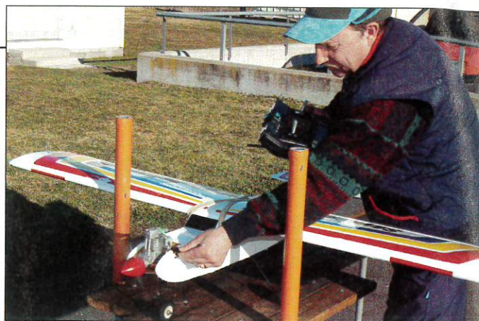
Les bancs de démarrage, dont tous les terrains devraient être pourvus (!), assurent une grande sécurité. Après un démarrage par l'avant, le réglage de la carburation se fait sans risque par l'arrière.
