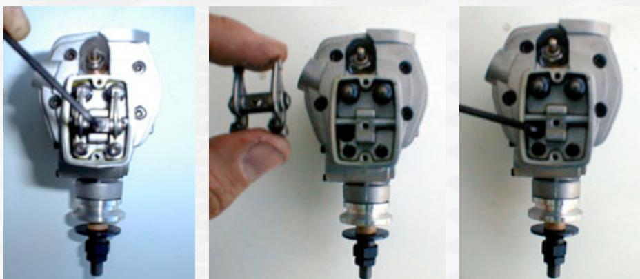
**Attention :** lorsque vous déposez la culasse, retirez les deux tubes aluminium de protection des tiges de culbuteurs ainsi que les tiges de culbuteur ; prenez garde à ne pas égarer les 2 petits joints toriques à chaque extrémité des tubes alu, soit 4 au total. Il peut arriver que ces petits joints restent collés dans leurs logements sur la culasse où le carter moteur, surtout si le moteur à déjà plusieurs heures de vol : retirez-les avec précaution.
