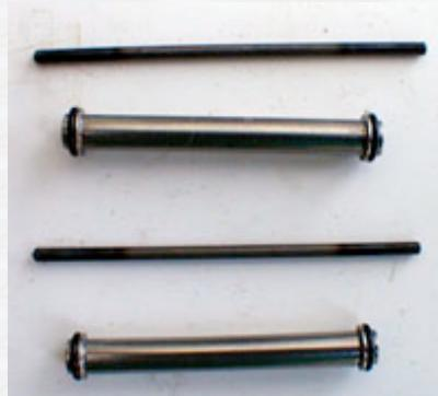
**Astuce :** les tiges de culbuteurs sont en fait des petits morceaux de corde à piano ( acier ) chargés de transmettre le mouvement des poussoirs aux culbuteurs . Ce sont des pièces particulièrement exposées en cas de retour vers la planète quelque soit peu violent.... Bref, après un retentissant
