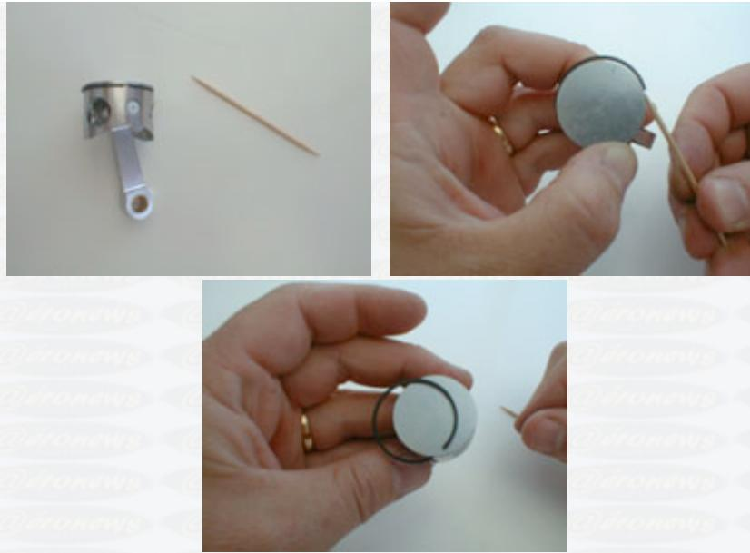
**Nota :** le segment a un sens de montage. Le côté du segment orienté vers le haut du piston, donc côté chambre de combustion doit être remonté dans le même sens. Sans rentrer dans les détails excessivement techniques, les segments ont une forme parfois spécifique avec un sens précis dirigé vers le haut du piston, et / où font l'objet d'un traitement thermique sur une face.
