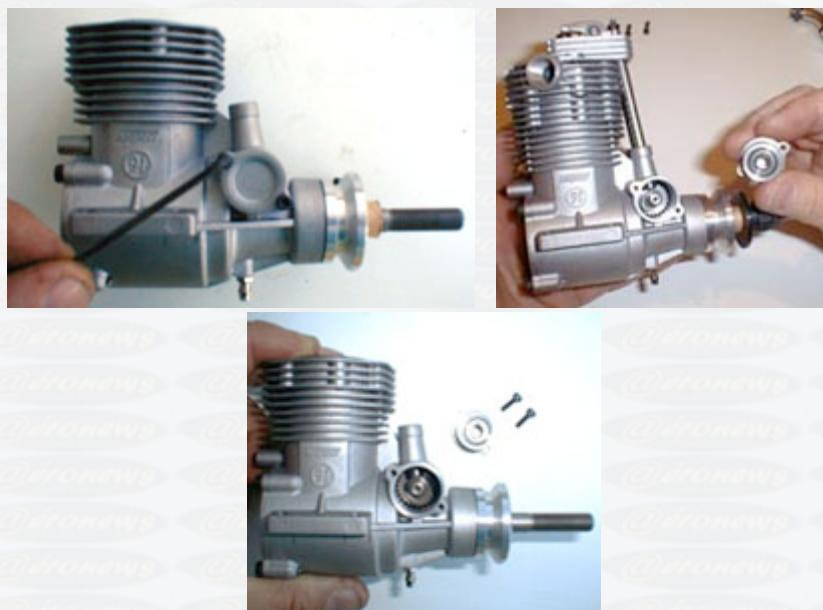
Avec un cure-dents en bois, repoussez le poussoir de tige de culbuteur qui se trouve face à vous, puis déposez le après avoir repéré son sens (partie lisse côté arbre à cames, partie creuse côté tige de culbuteur) et sa position (à droite où à gauche, côté admission où échappement du moteur).
