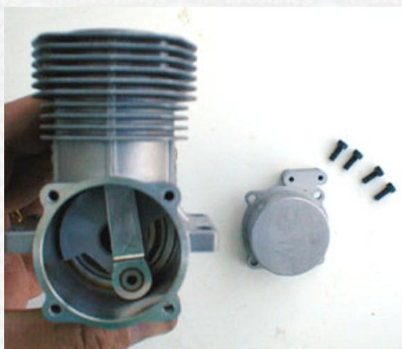
Dans le cas d'un moteur ayant déjà tourné, même très peu de temps, il faut repérer la position de la chemise et du piston : la chemise d'un moteur 4 temps n'est qu'un tube avec une collerette au sommet et doit être remontée exactement dans la même position qu'avant démontage : le repérage peut se faire avec une pointe à tracer d'une part sur l'extérieur de la collerette (en aucun cas sur la surface supérieure en contact avec le joint de culasse !) , et d'autre part sur la fonderie du carter
