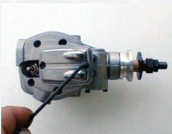
Avant de continuer le démontage, vous allez repérer le calage de la distribution de votre moteur : l'arbre à cames actionne des poussoirs qui poussent des tiges métalliques (tiges de culbuteurs) qui actionnent des basculeurs (culbuteurs) chargés d'ouvrir et de fermer les soupapes. Sur les premières générations de moteur de marque O.S., ces tiges étaient apparentes ; elles sont maintenant protégées par des tubes aluminium garnis de petits joints toriques pour l'étanchéité et la lubrification.
